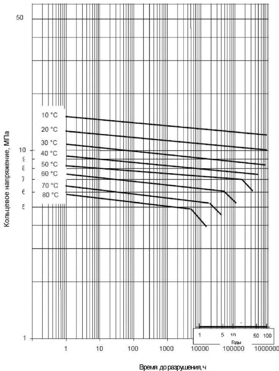
Левая часть ломаной:  $\lg t = -45,4007 + 28444,7344/T - 45,9891 \lg \sigma$
