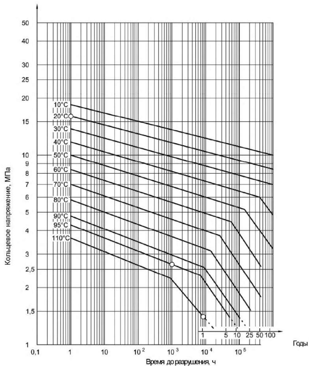
Левая часть ломаной:  $\lg t = -56,086 - (10157,8/T) \lg \sigma + 23971,7/T + 13,32 \lg \sigma$
