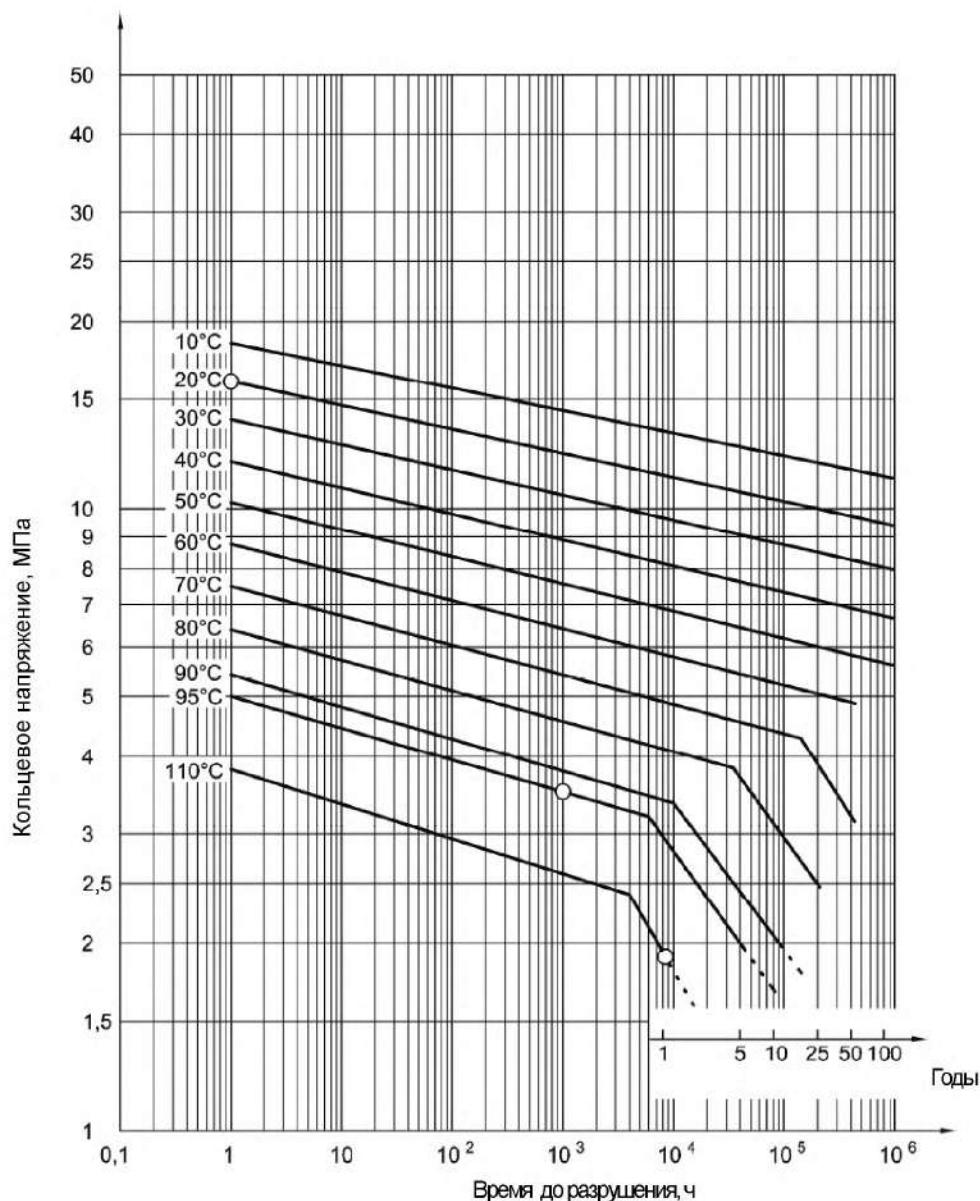
$$\text{Левая часть ломаной: } \lg t = -55,725 - \frac{9484,1}{T} \lg \sigma + \frac{25502,2}{T} + 6,39 \lg \sigma$$
