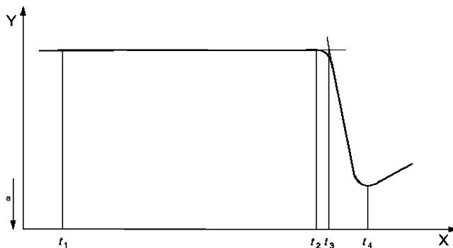
$X$  – время;  $Y$  – тепловой поток;  $a$  – максимум экзотермы;  $t_1$  – переключение на кислород или воздух (время ноль);  $t_2$  – начало окисления;  $t_3$  – точка определенная методом касательной;  $t_4$  – максимум окисления
