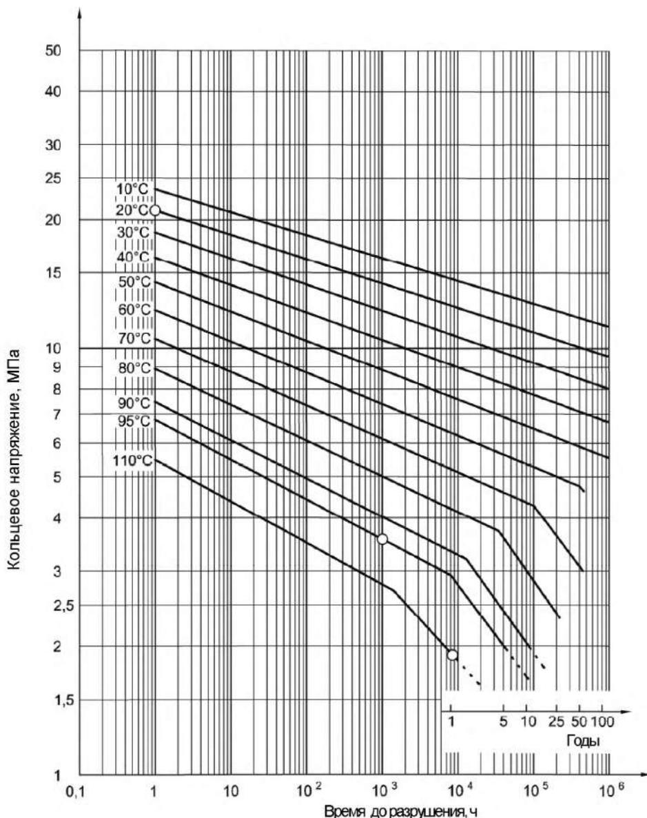
Левая часть ломаной:  $\lg t = -46,364 - (9601,1/T) \lg \sigma + 20381,5/T + 15,24 \lg \sigma$
