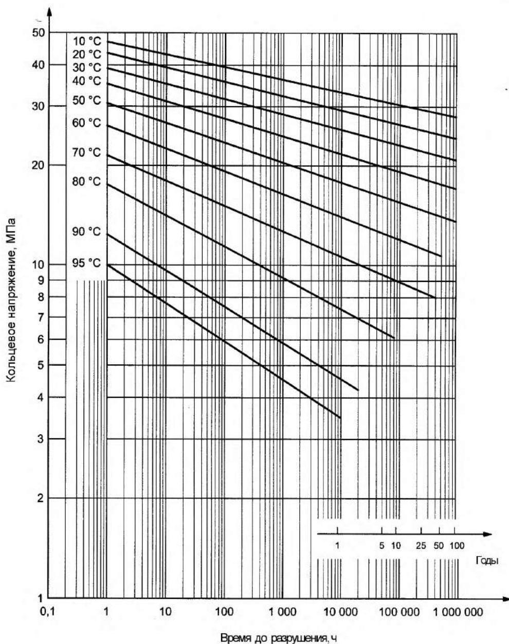
$$\lg t = -109,95 - \frac{21897,4}{T} \lg \sigma + \frac{43702,87}{T} + 50,74202 \lg \sigma,$$
