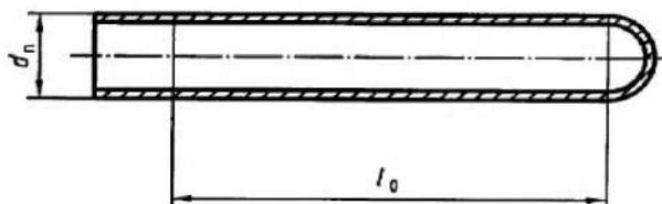
Рисунок 1 – Образец в форме трубы, изготовленный литьем под давлением
