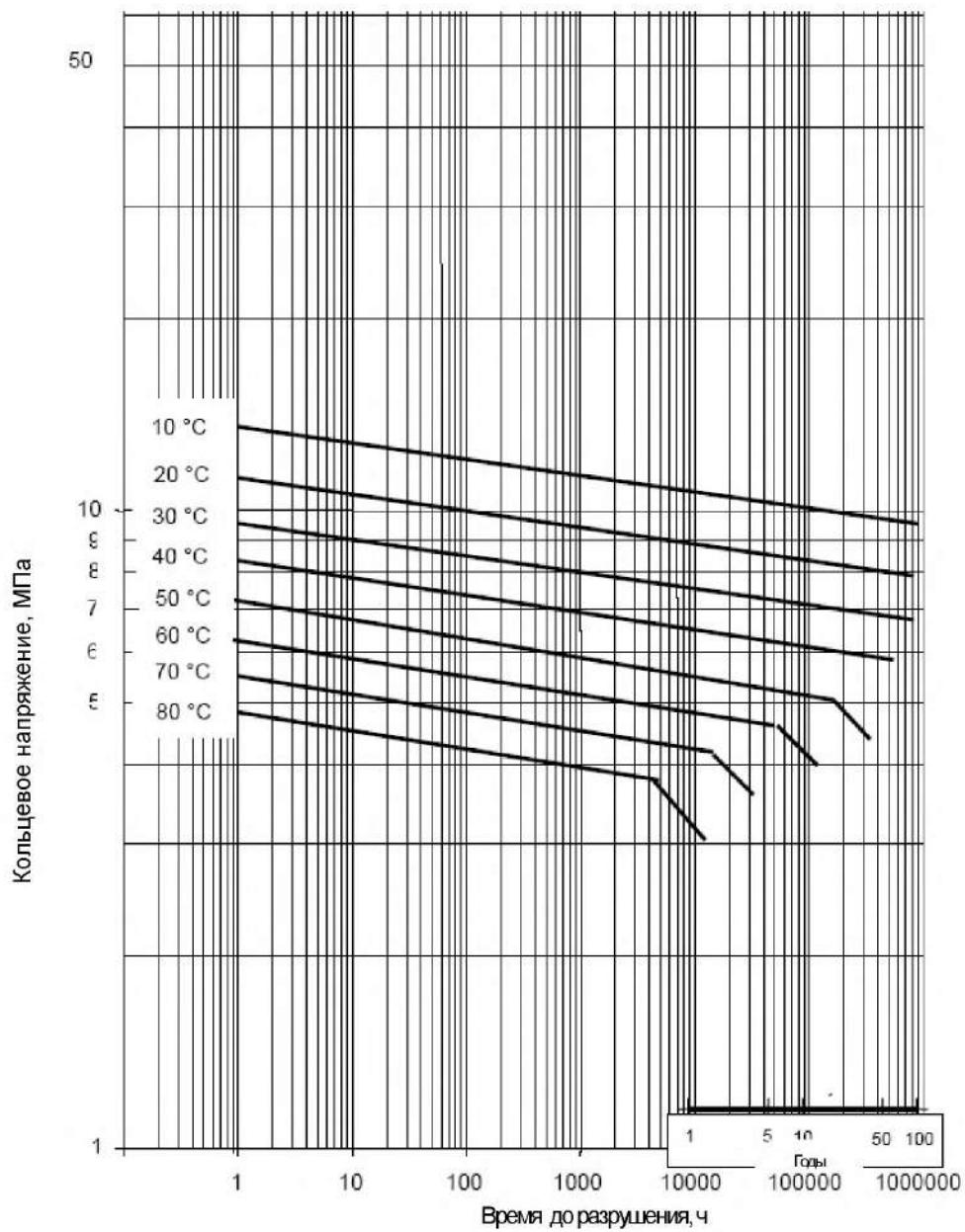
Левая часть ломаной:  $\lg t = -42,5487 + 24074,8253/T - 37,5758 \lg \sigma$
