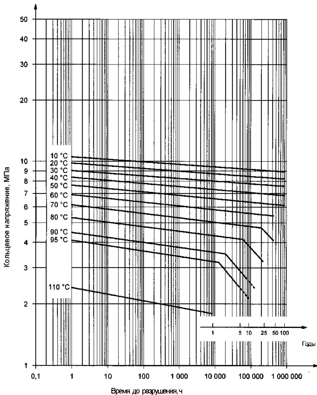
Левая часть ломаной:  $\lg t = -190,481 - (58219,035/T) \lg \sigma + 78763,07/T + 119,877 \lg \sigma$
